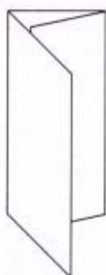
A4 falsad två gånger (parallellfalsning) 6 sidor 99 x 210 mm – passar för standardkuvert E65 (se sid 82). Kom ihåg att den del som viks inåt måste vara något smalare (4 mm) än de andra två sidorna. Annars kommer trycksaken inte att ligga plant ihopvikt.
